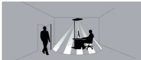
Fig. 12: Zone de détection de Détecteur PIR.
