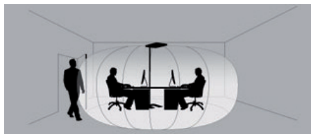
Fig. 11: Zone de détection de Détecteur HFMD.
